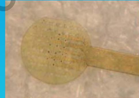
Détection électrochimique du glucose via l'immobilisation sur la surface de l'électrode diamant de l'enzyme spécifique du glucose oxydase
